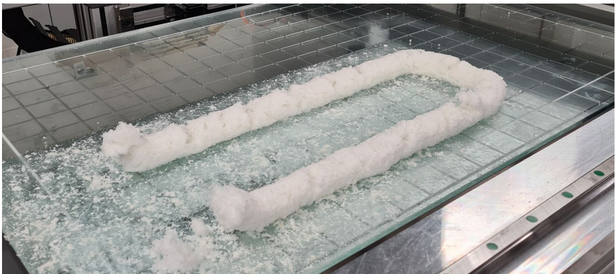
Abbildung 6.20: Druckergebnis mit optimierter Extruderdüse
