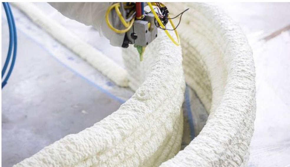
Abbildung 2.16: Additive Fertigung mit Polymerschäum [3dn20]
