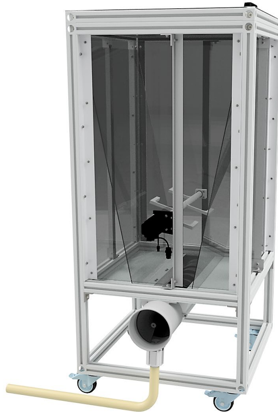
Abbildung 5.8: Materialspeicher und -fördereinheit
