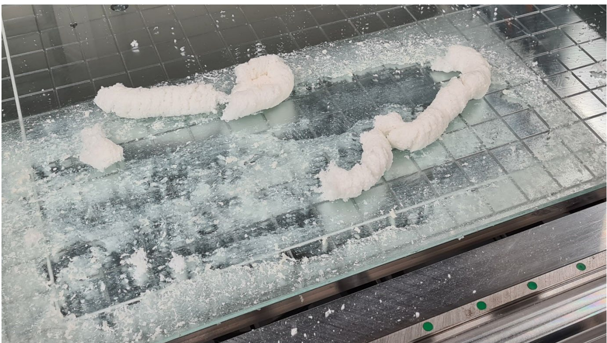
Abbildung 6.18: Druckergebnis bei Fehleinstellung (zu viel Material / zu wenig Wasser)
