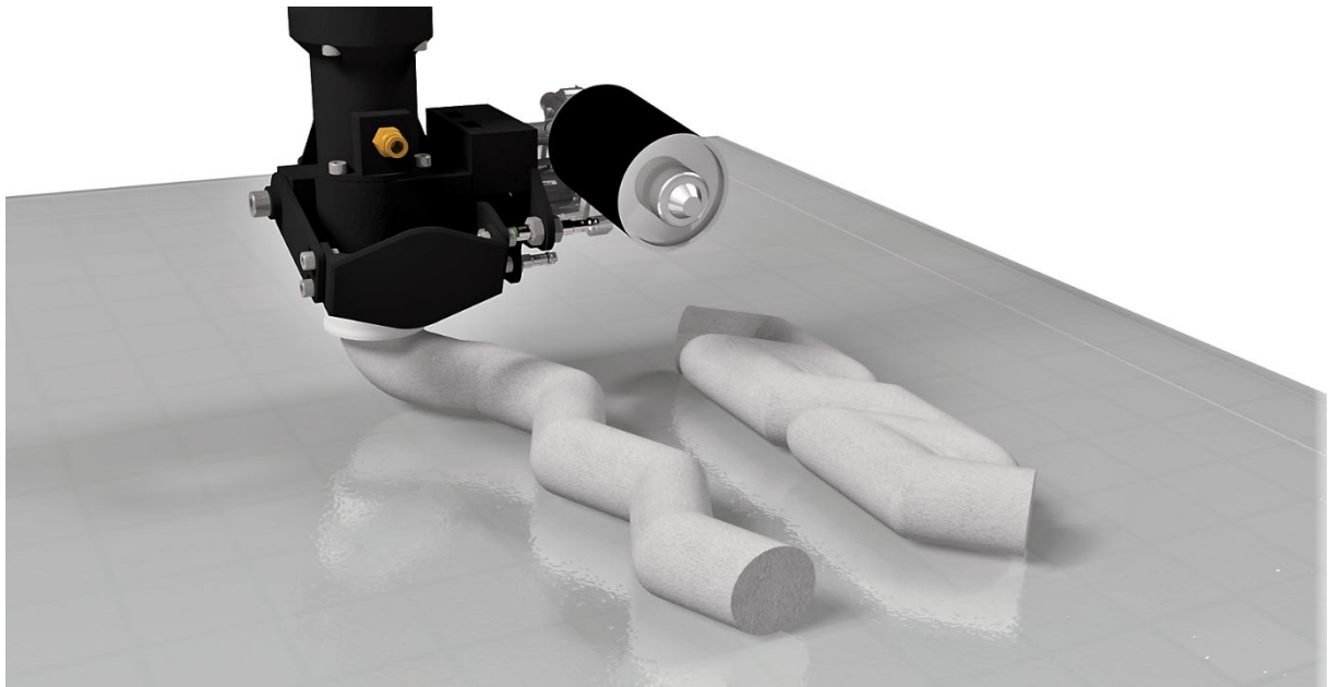
Abbildung 8.6: Soll- und Ist-Kontur der Strangablage
