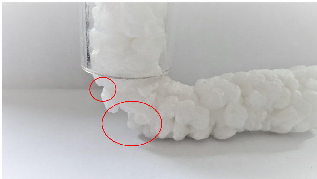
Abbildung 4.3: Ablage eines Materialstrangs aus FFC
