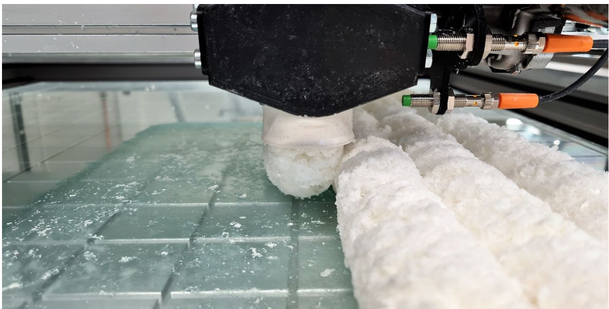
Abbildung 6.21: Strangablage nebeneinander mit einem Abstand von 42 mm
