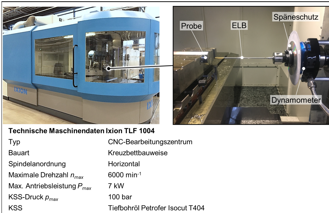
Abbildung 4-5: Tiefbohrmaschine für Versuche unter Tiefbohröl
