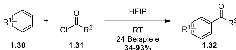
Schema 8: Katalysatorfreie intermolekulare FRIEDEL-CRAFTS-Acylierung. [58]
