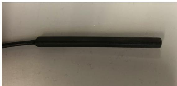
**Abbildung 3.2:** Bild des verwendeten, schwarz lackierten Szintillationsdetektors.
