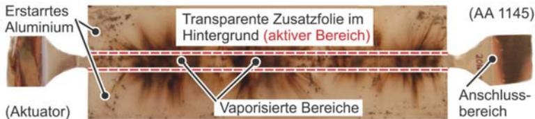
**Bild 2.8:** Niederenergetische Vaporisation mit 200 mm aktiver Länge (Hansen, 2018).
