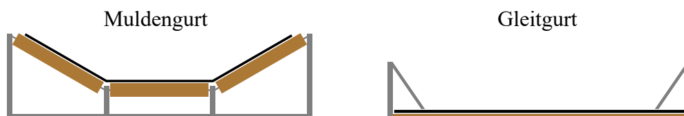
Abbildung 2.14: Mulden- und Gleitgurt im Profil. Muldengurte werden in der Regel von Tragrollen gehalten, während Gleitgurte auf einer Metallplatte gleiten und das Material durch Seitenwände vor dem Herabfallen geschützt wird.
